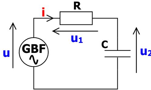
On a  $U=5V$ ,  $f=1000Hz$ ,  $R=1k\Omega$  et  $C=0,2\mu F$
