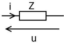
On a  $u = U\sqrt{2}\sin(\omega t + \varphi_u)$  et  $i = I\sqrt{2}\sin(\omega t + \varphi_i)$
