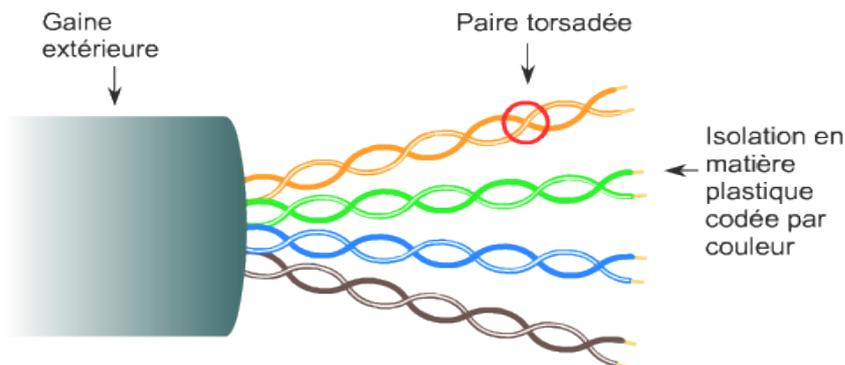
Afin de minimiser les phénomènes d'induction **électromagnétiques parasites** provenant d'un environnement **critique** (*moteur électrique, néon...*), il existe aussi un câble appelé **FTP** pour **Foiled Twisted Pairs** (une feuille métallique entoure tous les conducteurs pour isoler des parasites l'ensemble des conducteurs : **écranage**).
